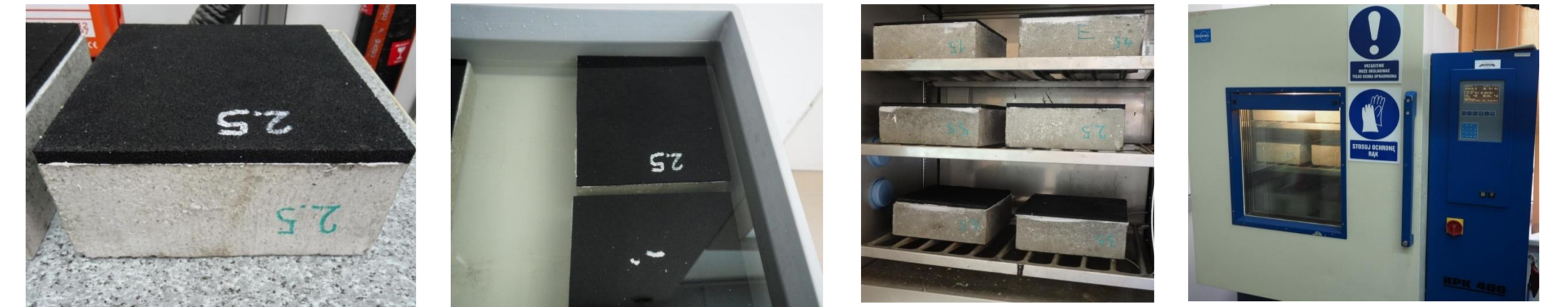
Próbka podkładki USP przymocowana do betonowej kostki (symulującej podkład) – nasączona wodą i umieszczona w komorze klimatycznej (zamrażanie i rozmrażanie).
