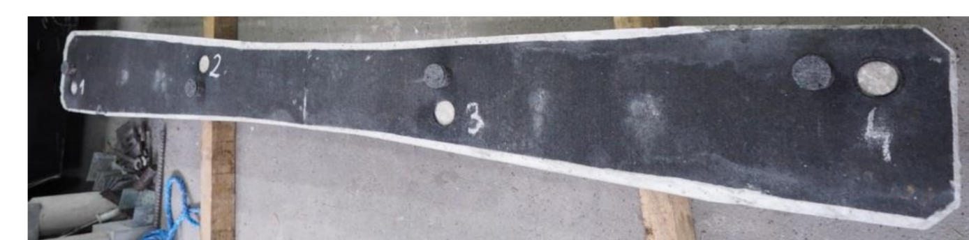
Podkład kolejowy PS-94 z podkładką USP po badaniu przyczepności przez odrywanie.
