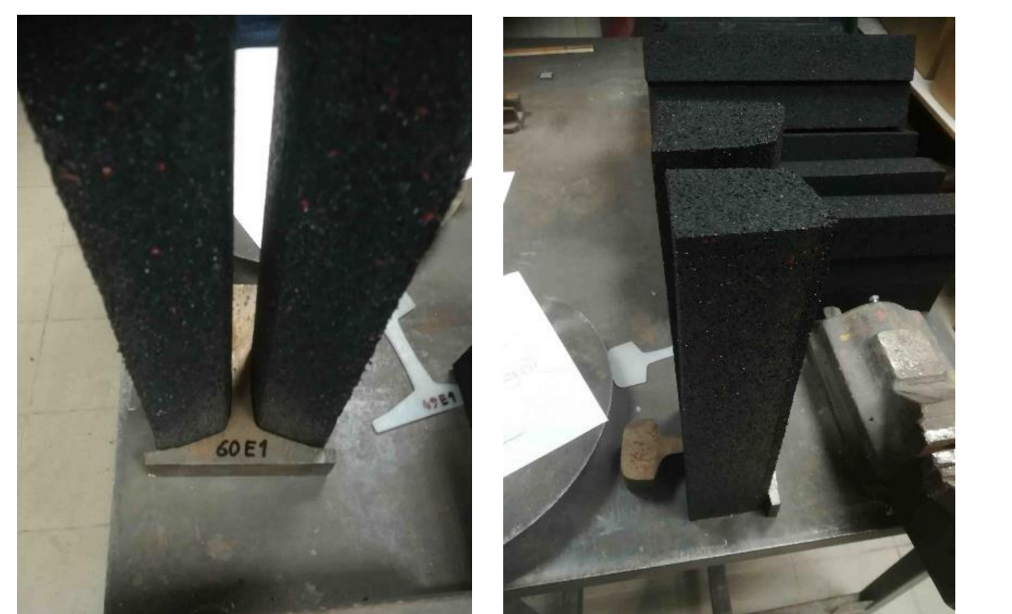
Prototypy tłumików przyszynowych (szyna o profilu 60E1 i 49E1) do badań laboratoryjnych i poligonowych.
